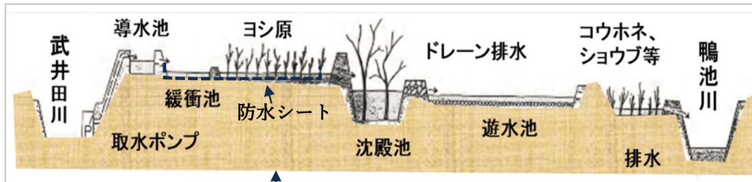
図 6-1 ヨシ実験圃場の計画図面 1992 年
