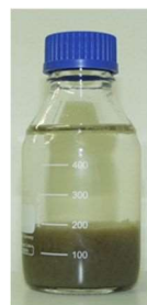
最終沈殿池で微生物が沈む
