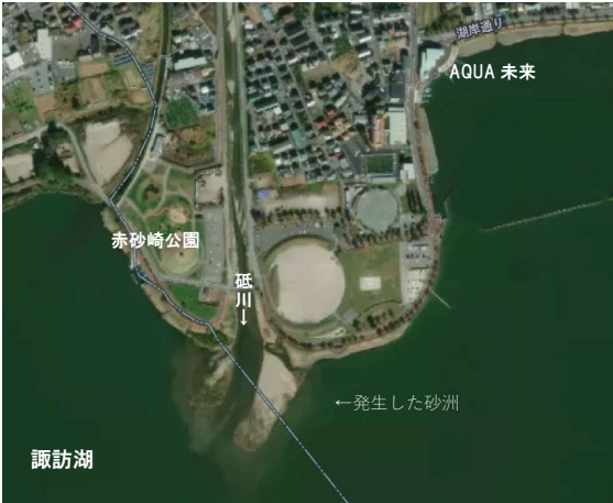
砥川の河口にできた砂洲を上空から 形状 200m×200m 砂洲の形状から諏訪湖の水の流れが釜口水門に向かってい ることがわかります
