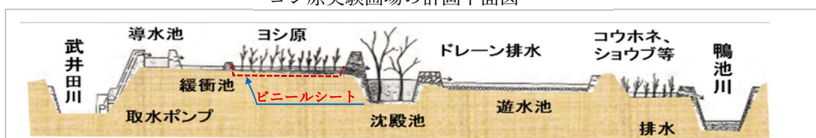
ヨシ原実験圃場の計画断面図
